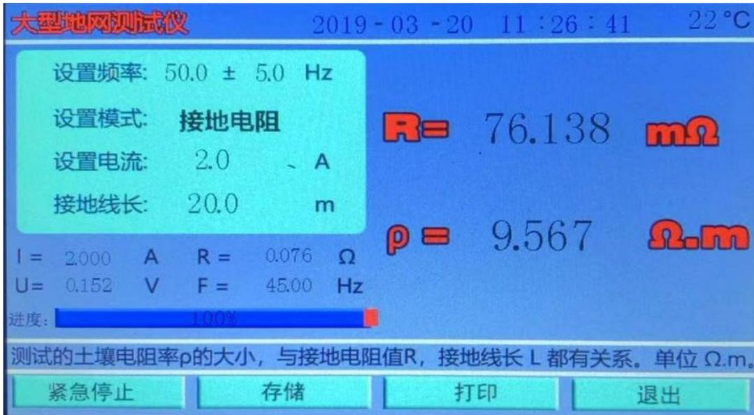
图 16 接地电阻测试结果界面
